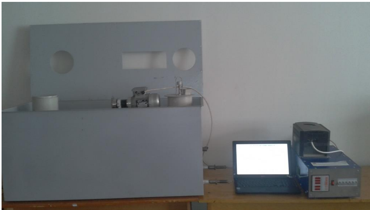
Рис. 2.4. Реактор поміщено у ванну із водою
