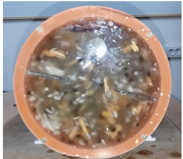
Рис. 3.4. Візуалізація інтенсивності перемішування субстрату при кутовій швидкості обертання реактора 0,1 рад/с (інтенсивність достатня)
