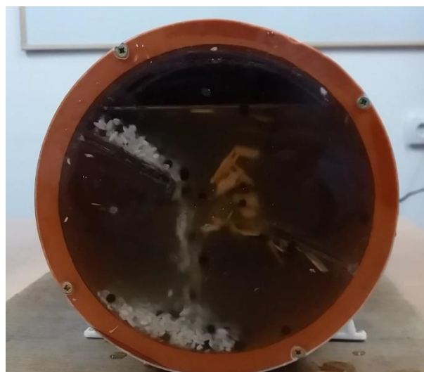
Рис. 3.3. Візуалізація інтенсивності перемішування субстрату при кутовій швидкості обертання реактора 0,05 рад/с (інтенсивність недостатня)
