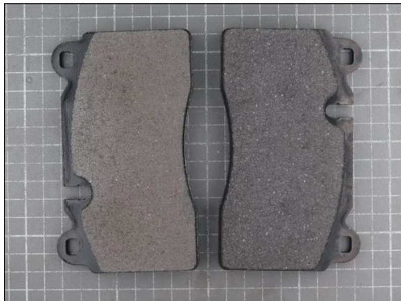
Рис. 2.3. Органічна (зліва) та неорганічна (справа) гальмівна колодка
