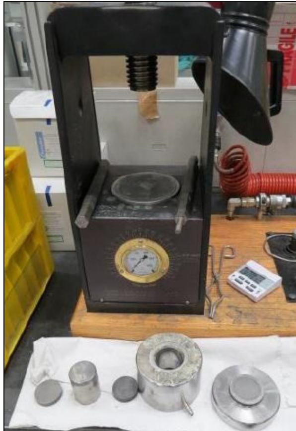
Рис. 2.1. Прес для виготовлення дослідних зразків.
