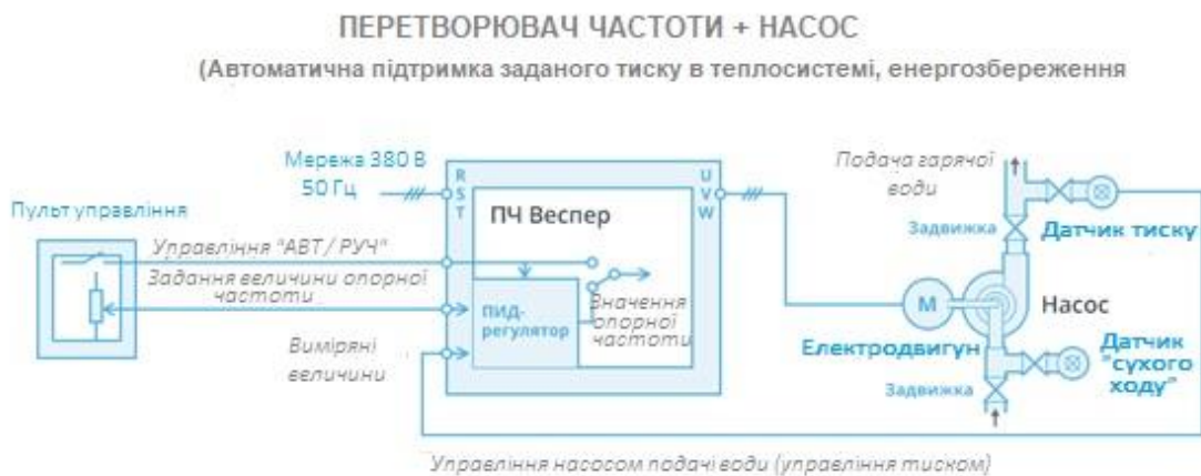
Рисунок 1.2. Схема роботи системи ПРЧ + насос
