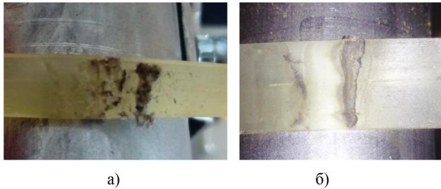
Рис. 3.7. Частинки зносу поліуретанового зразка: а – частинки зносу поліуретанового зразка при стиранні циліндричним штовхачем ковзання; б – частинки зносу поліуретанового зразка при стиранні роликовим штовхачем
