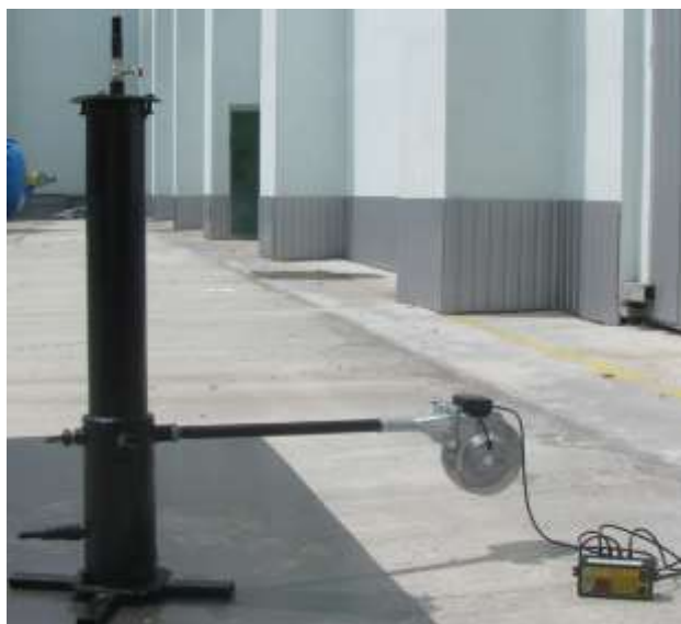
Рис. 2. Дослідна установка у складі генератора горючого газу, вентилятора, системи керування
