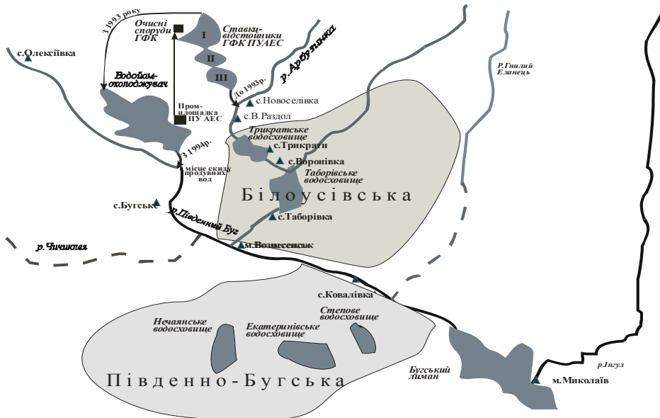
Рис. 1. Схема формування водних обсягів Південно-Бугської та Білоусівської зрошувальних систем
