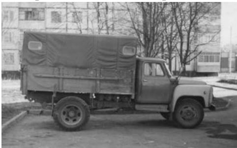
Рис. 2. Закритий кузов автомобіля ГАЗ-53
