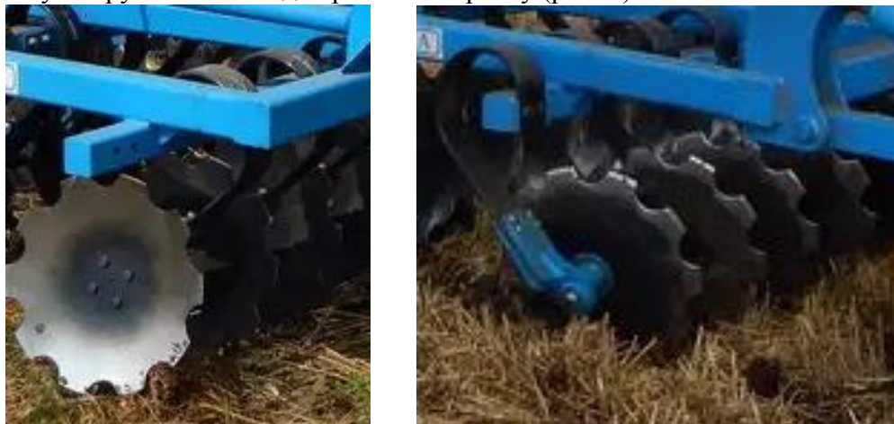
Рисунок 1 – Пружні стояки дискових робочих органів
